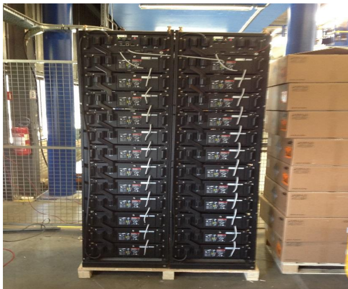
Figuur 17 Seriegeschakeld LiNMC accupakket van Alfen
