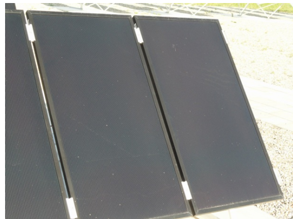
Foto 4: dunne film CIS panelen van Sulfurcell
