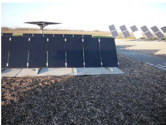
Foto 14: Schaduw van vaste op variabele Sulfurcell opstelling
