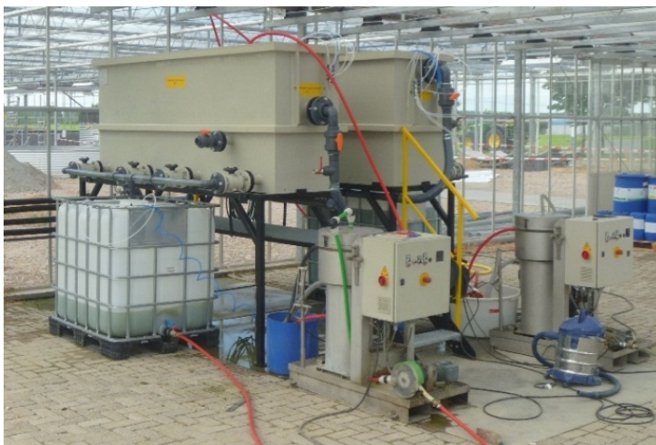
Foto 4. Overzicht van het oogststelsel. Op een frame staan de coalescers (bovenin de foto) voor de twee algenvijvers, 24 uur per dag stroomt algencultuur door de coalescer en een klein gedeelte van de algen bezinkt. Dagelijks worden de coalescers geoogst waarbij de inhoud van de coalescers terecht komt in het onderstaande kuubsvat (links op de foto). Vandaar wordt de cultuur gecentrifugeerd met behulp van de beide centrifuge (voor op de foto)
