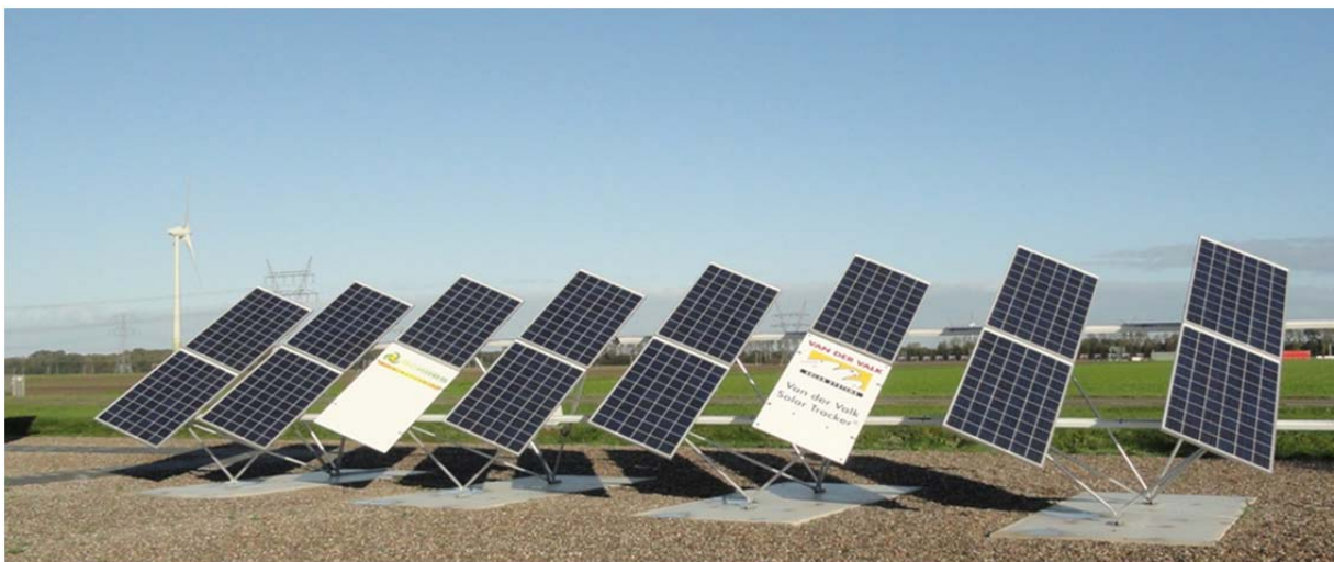
Foto 8: Van der Valk solar-tracker (over 1 as) met Solarpark panelen
