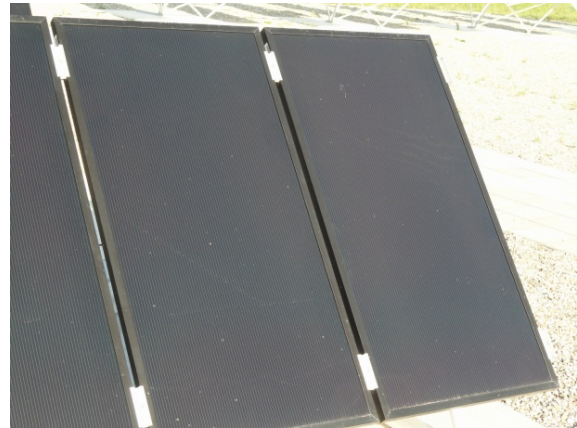
Foto 4: dunne film CIS panelen van Sulfurcell
